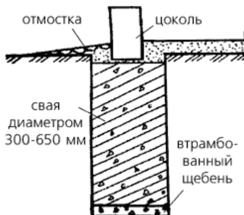
Рис. 5.5. Буронабивной фундамент.
