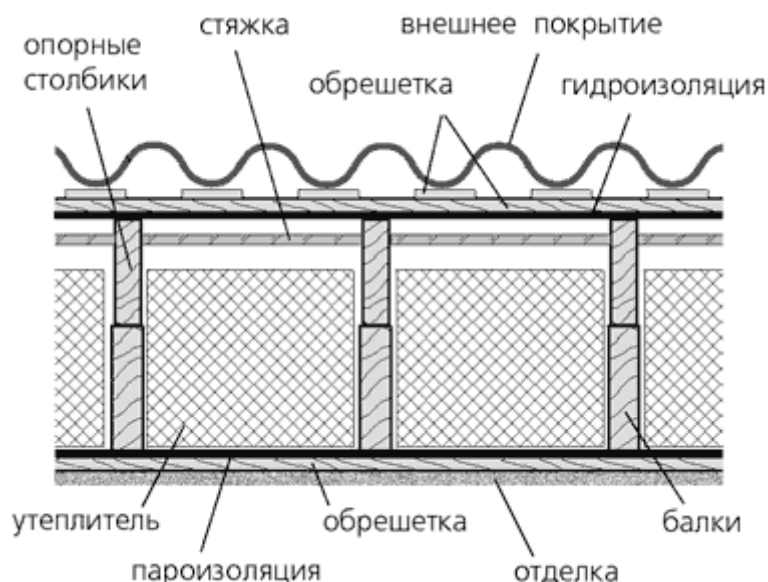
Рис. 5.15. Конструкция утепленной крыши.
