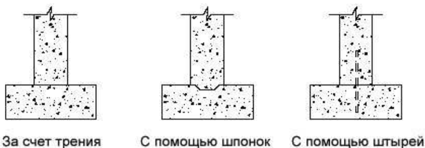
Рис. 5.7. Схемы соединений стен фундаментов с уширениями
