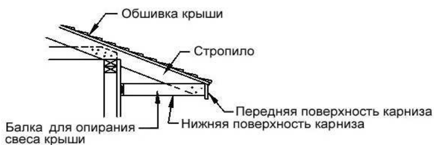
Выступающий свес карниза (из стропил)
