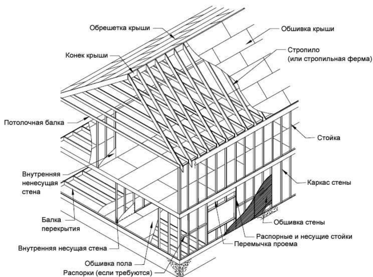
Рис. 4.1. Конструктивные элементы и связи каркасного деревянного дома
