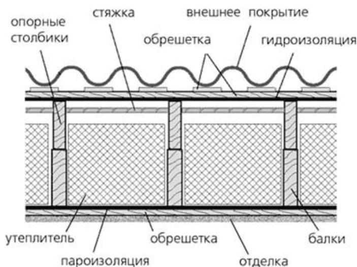
Рис. 5.15. Конструкция утепленной крыши.
