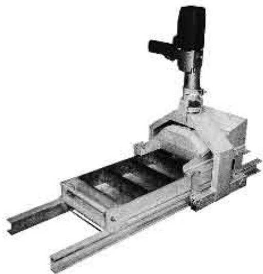
Комплект формовочный МН-05 - ручной механизированный инструмент (“мини-нагнетатель”), предназначенный для изготовления строительных изделий и элементов (кирпичей, блоков, стоек, подоконных плит и др.) в условиях индивидуальной работы. В качестве сырья для этого оборудования могут быть использованы маловлажные сыпучие смеси: жесткие бетоны, грунт (суглинки, супесь), промышленные отходы и другие материалы.
